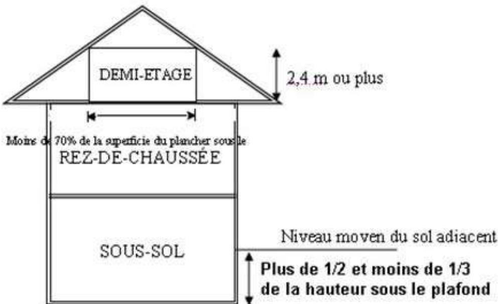
**Figure 16 - Hauteur et rez-de-chaussée**
