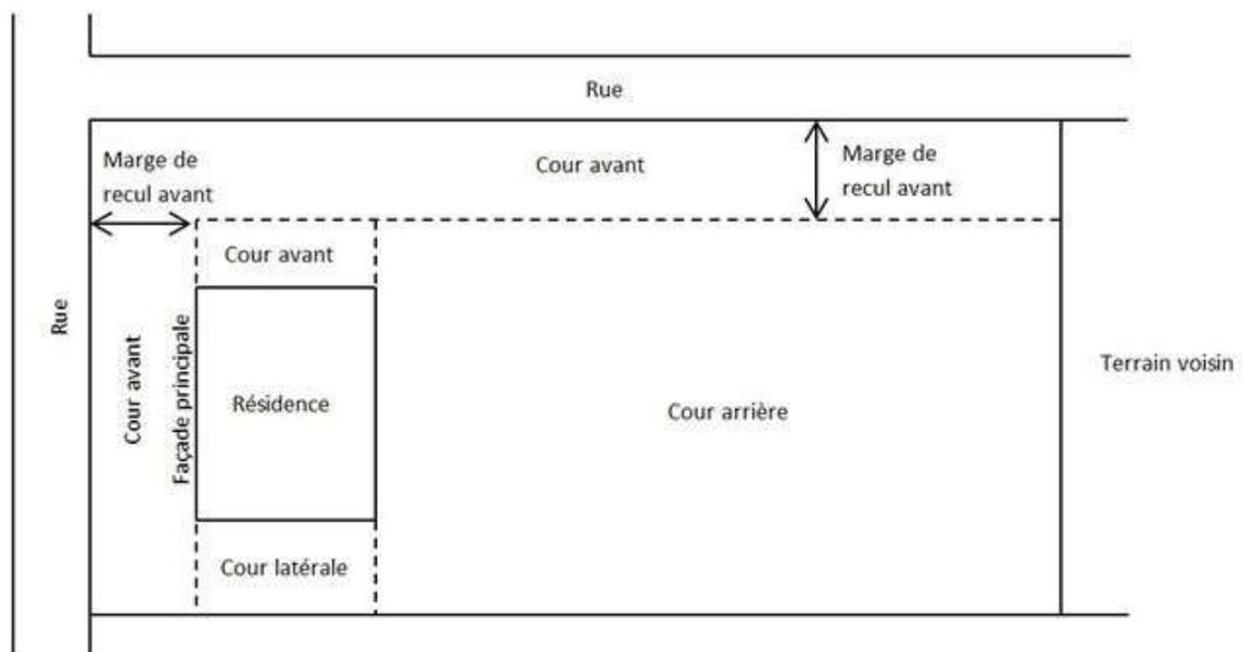
Figure 9 - Terrain d'angle transversal - lignes de terrain, marges de recul et cours
