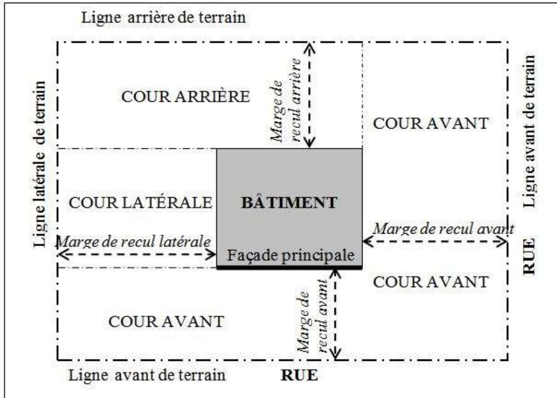
Figure 8 - Cours d'un terrain d'angle
