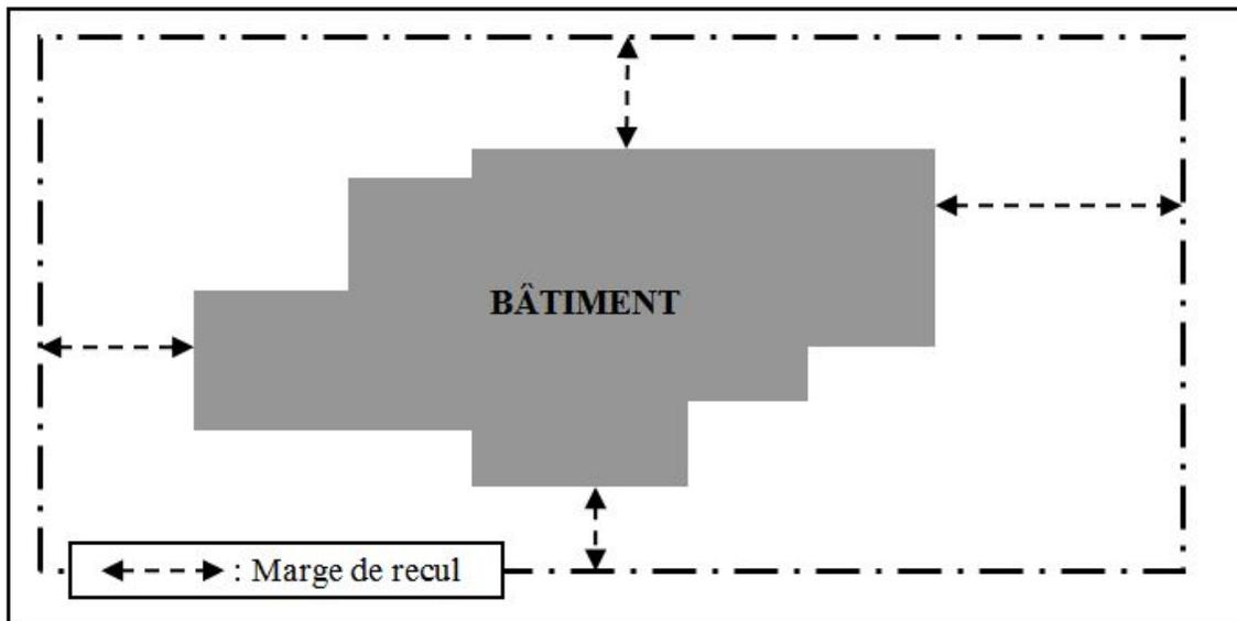
Figure 3 - Marge de recul avant en zone construite
