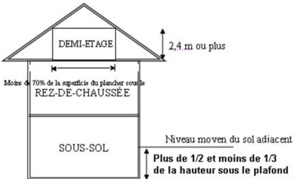
Figure 16 - Hauteur et rez-de-chaussée
