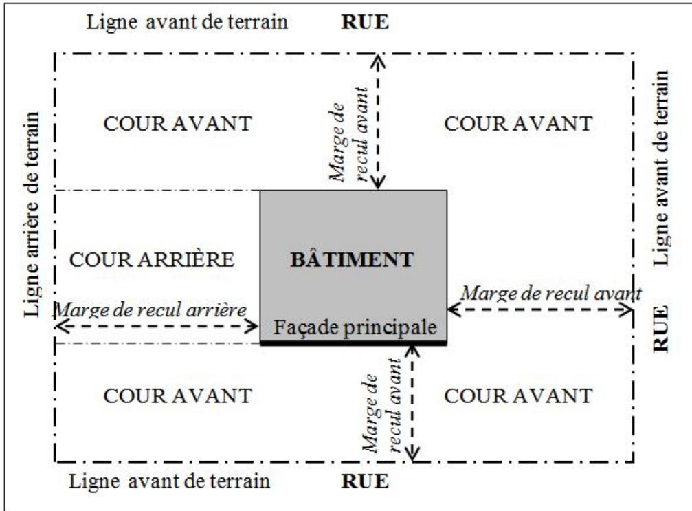
Figure 10 - Terrain transversal - lignes de terrain, marges de recul et cours
