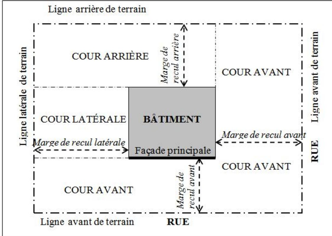
Figure 8 - Cours d'un terrain d'angle
